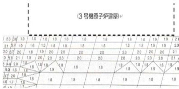
(注)以前の3号機の原子炉直下の地盤の局所安全率の例。動解時のすべり安全率(目安値)は1.5
