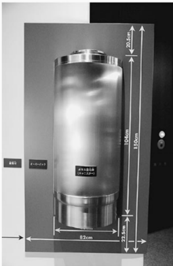
高レベル放射性廃棄物を取るガラス固化体の模型
