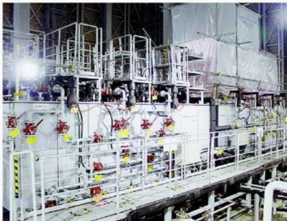
③上空から見た福島第1原発。今年2月 ④高濃度汚染水に含まれる62種類の放射性物質を放出基準値未満まで低減できるとされる「アルプス」(多核種除去設備)。トリチウムは除去できません(東京電力提供)
